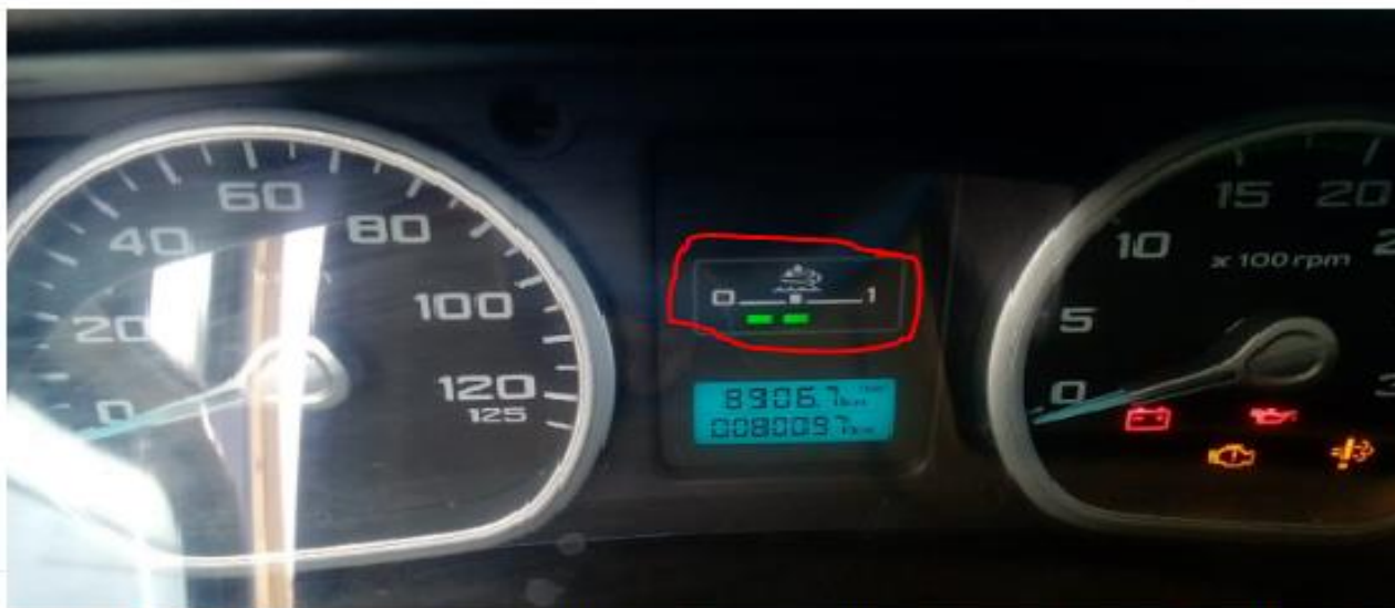
Figura 04: nível do reagente Arla-32 no reservatório do caminhão Ford 816 – S
